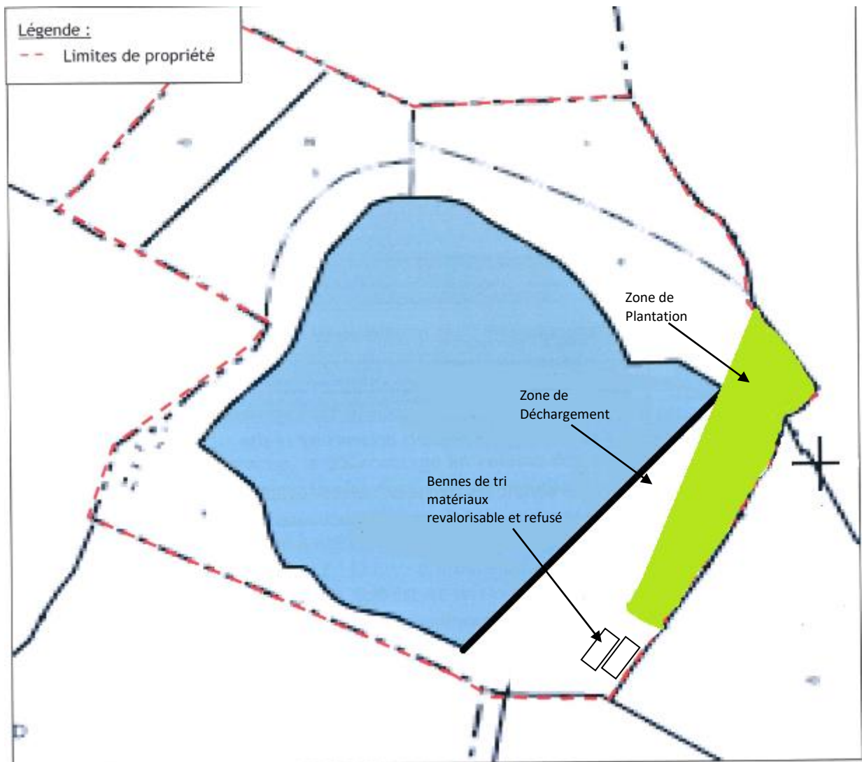
Figure 15 : Localisation des zones de stockage sur un plan du site, au cours de la première phase d'exploitation
